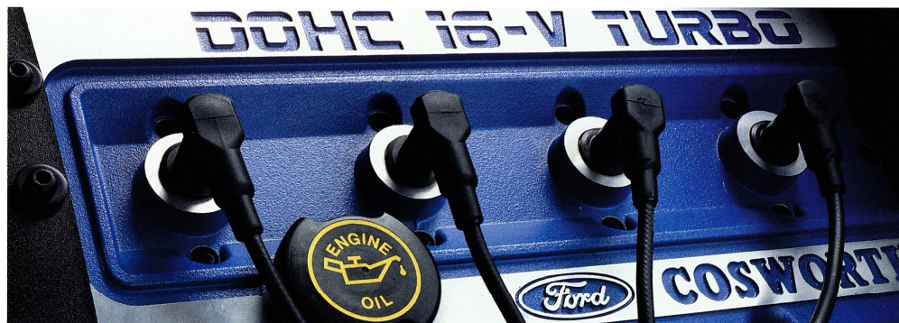
Das 2,0 Liter DOHC-Aggregat mit 16 Ventilen und regeltem Dreiegekatalsator stellt Ihnen 162 kW (220 PS) zur Verfügung und erreicht schon bei 2500 U/min sein maximales Drehmoment von 290 Nm.
